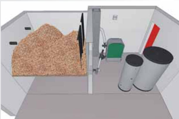
trasporto con coclea flessibile (2 Spira della coclea)
